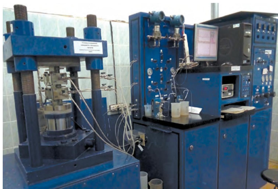
Рис. 1. Установка по определению проводимости и проницаемости пропантов
